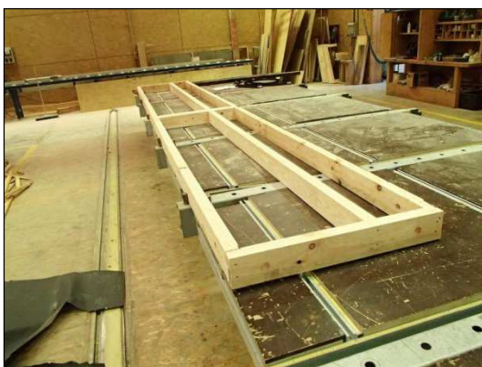
Figura 6. Fabricación de panel estándar en EGOIN
